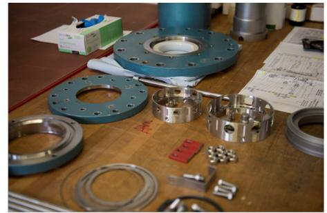
In unserem Produktions- und Service- Center auf 1400 m<sup>2</sup> in Basel revidieren wir Gleitringdichtungen unabhängig vom Hersteller.
