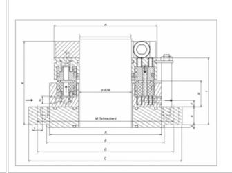
Für emaillierte Kessel nach DIN 28138, Teil 2 Typ: ARG-DIN-VE
